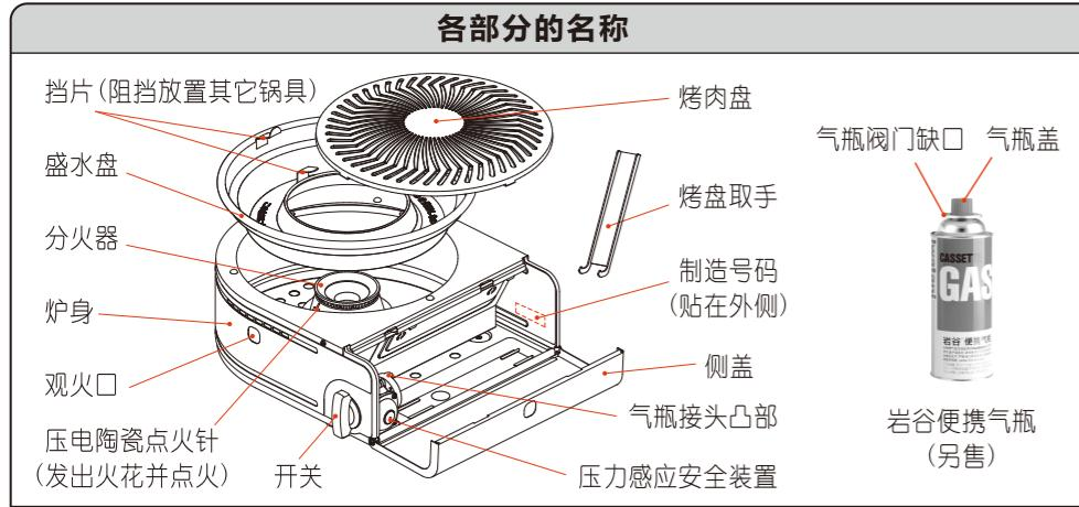
\* 操作时手必须触及的部位：开关；手可能触及的部位：炉身；手不易触及的部位：侧盖
